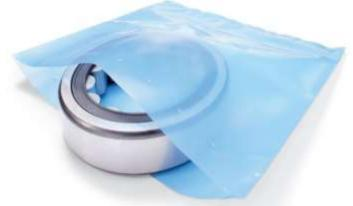
Der Korrosionsschutz geschieht durch Oberflächenneutralisierung. Im Gleichgewichtszustand der VCI-Schicht wird der VCI-Wirkstoff nicht mehr vom Metall angezogen. Es verbleibt fest auf dem Metall sitzen, bis es durch einen Luft- oder Wasserstrom mechanisch entfernt wird. Das VCI "regeneriert sich selbst", indem es auf die noch verbleibenden Reserven in der VCI-Folie zurückgreift.
